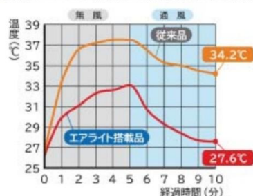
従来品とエアライト搭載品の頭頂部付近の温度変化比較
